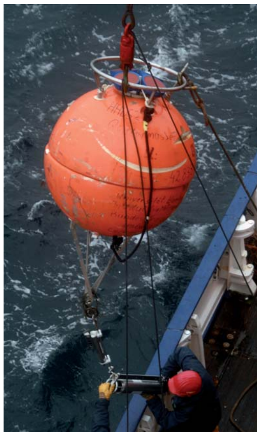
Abbildung 7. Links: Bergung eines akustischen Strommessers, der ein Jahr lang geschützt durch die orangefarbene Auftriebskugel in der Dänemarkstraße verankert war. Die Sender/Empfänger der akustischen Signale sind im oberen Teil der Kugel als blau umrandete Scheiben zu sehen. Rechts: schematischer Aufbau der gesamten Verankerung.
